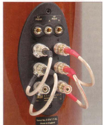
Das aufwendige Tri-Wiring-Terminal beeinflusst optional Bässe und Höhen
